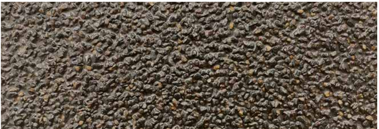
Absandung mit Hartkorn grob im Überschuss inkl. transparenter Versiegelung - Rutschhemmung R13
